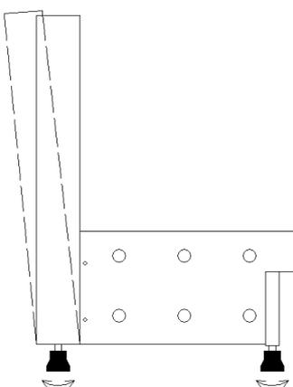
Мы рекомендуем поставить штатив под небольшим углом, чтобы при нагрузке на стеллаж он встал в вертикальное положение.
