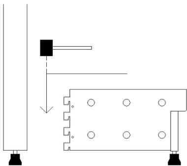
**II.** Вставьте стопорный болт в отверстие штатива и затяните гайку.
